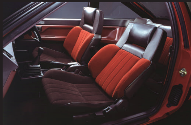
座椅配備了具有側面支撐調整功能的運動座椅。在座椅左側，有一個氣壓幫浦，用來調整駕駛座的腰部支撐。
