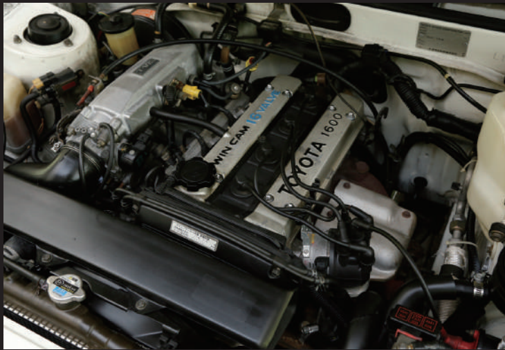
它搭載了新開發的4A-GEU型DOHC引擎，每缸採用4個氣門，共16個氣門。
