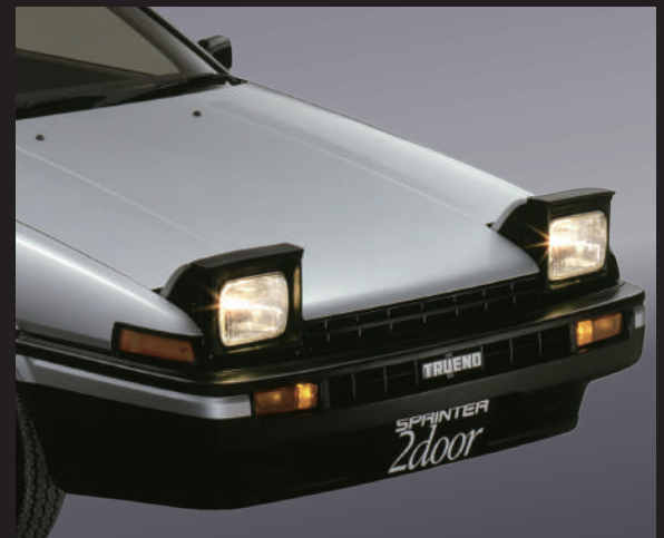
Sprinter Trueno為了區別兄弟車型Corolla Levin，採用收納式頭燈，提高了差異性。升起收納式頭燈時，外觀也有明顯的變化。
